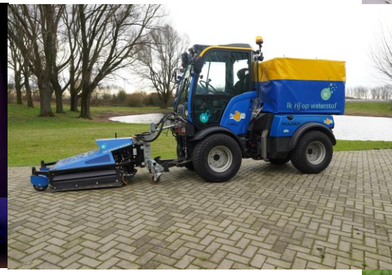
Dual Fuel Tractor en Holder; 60-80% waterstof bijmengen mogelijk
