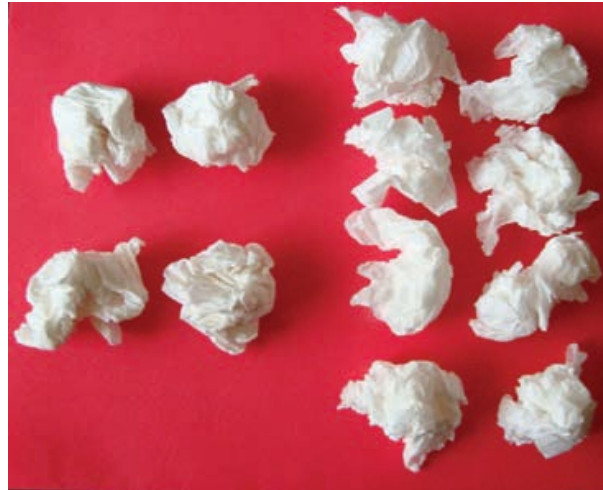
Links papier met hoge treksterkte (4 ballen / 24 vellen), rechts papier met lage treksterkte (8 ballen / 48 vellen)
