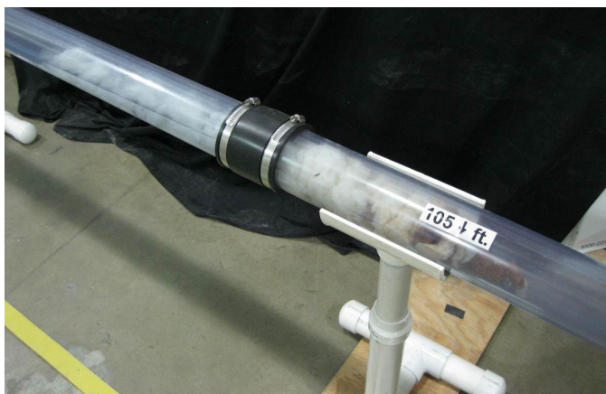
Volle leiding die de luchtstroom binnen de testopstelling blokkeert
