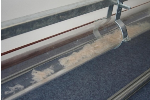
Toiletpapier zet lichtelijk uit en valt uiteen in een wollige massa (ST-14).
